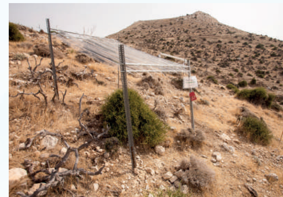
Πειραματικά τεμάχια και στέγαστρα για την προσομοίωση ξηρασίας (Φωτογραφία του Erik van den Elsen)
